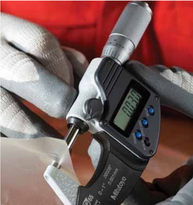
测量挤出APTIV PEEK膜的厚度。
